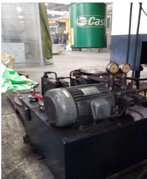
Slika 4.5. EM koji pogoni pumpu za centralno podmazivanje stroja, (Fotografirano 12.11.2017.)
