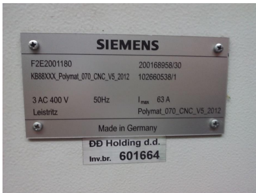
Slika 4.37. Natpisna pločica koja se nalazi na strujnom ormaru stroja za dubljenje utora zupčanika, (Fotografirano 12.11.2016.)
