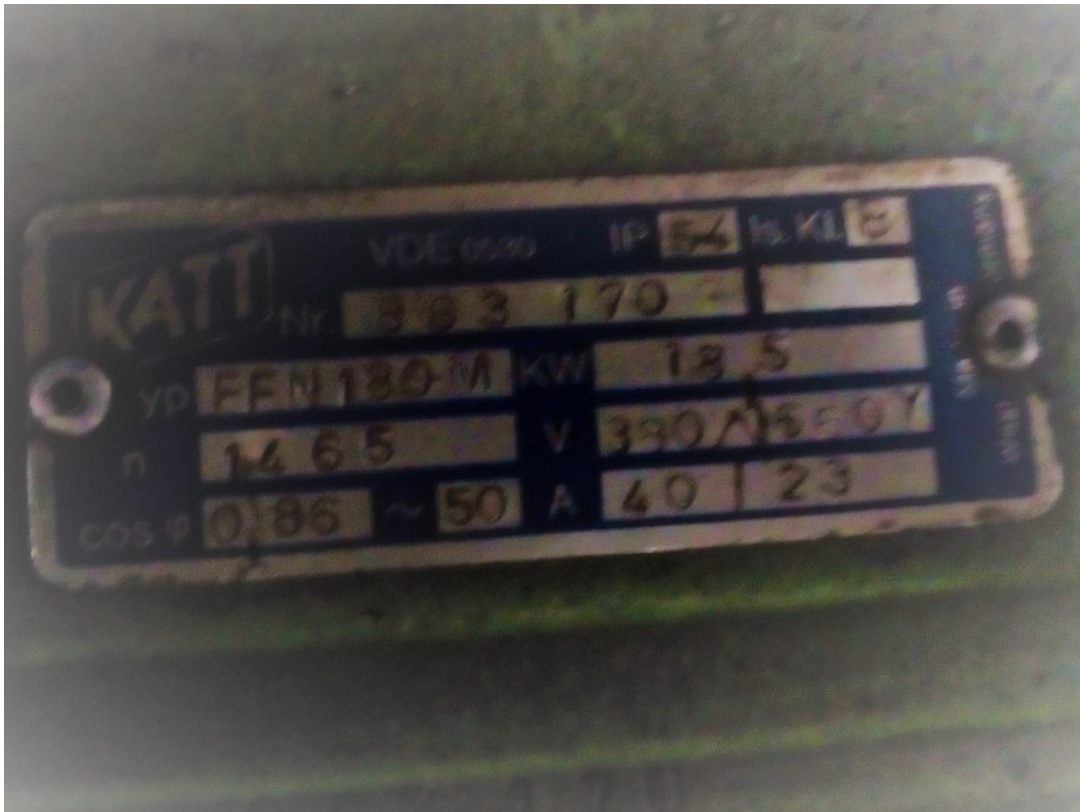
Slika 4.45. Natpisna pločica motora glavnog pogona, (Fotografirano 12.11.2016.)
