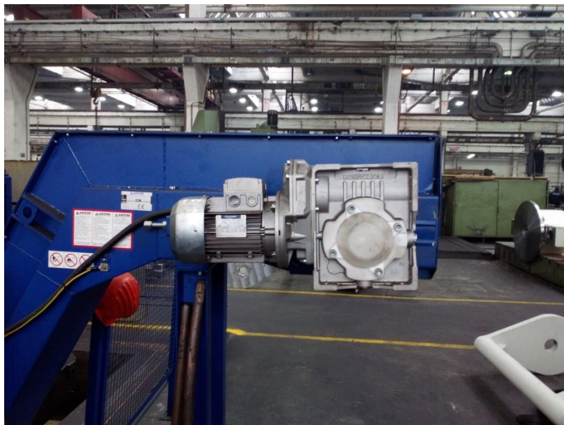
Slika 4.11. Pužni prijenos, (Fotografirano 12.11.2016.)
