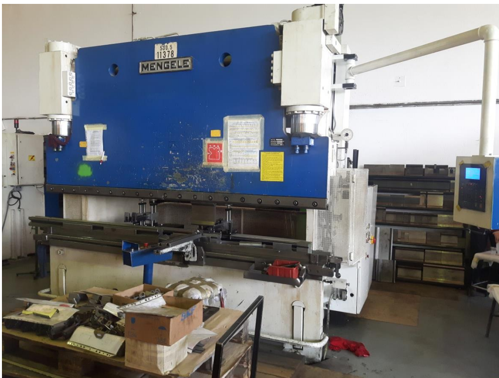
Slika 2.4. Stroj za deformaciju MENGELE
