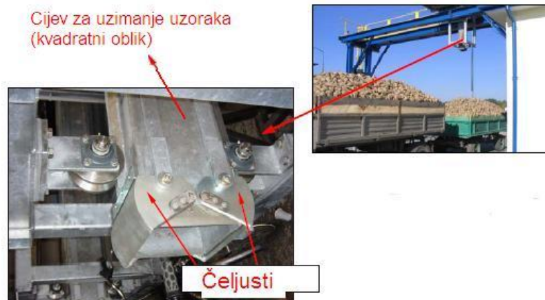
Slika 5.5 Čeljusti sonde za uzimanje uzoraka [2]
