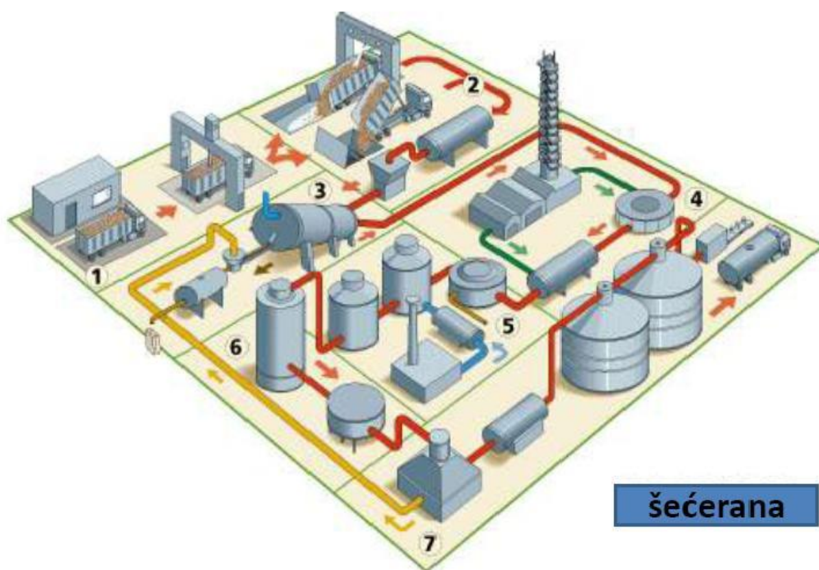
Slika 3.1 Vizualni prikaz svih osnovnih postrojenja i tehnološkog slijeda u jednoj šećerani [1]
