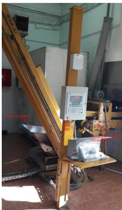
Slika 4.4 Transportna traka i bruto vaga
