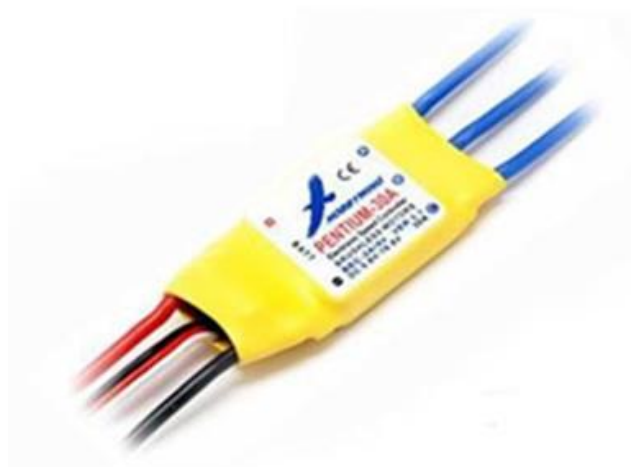
Slika 3.8. Električni kontroler brzine (ESC).
