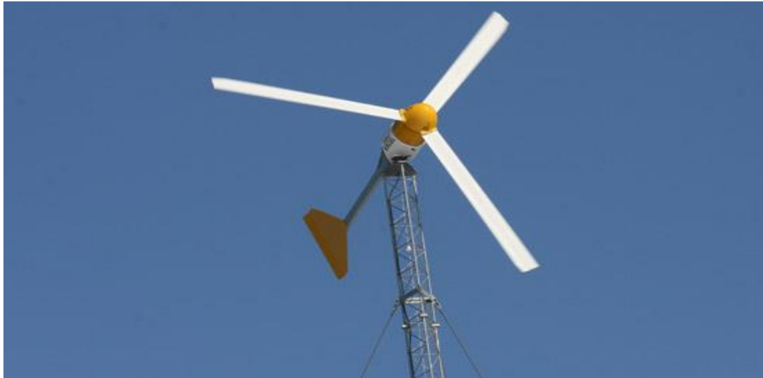
Slika 4.10. Trubina Bergey Excel snage 6 kW [34]
