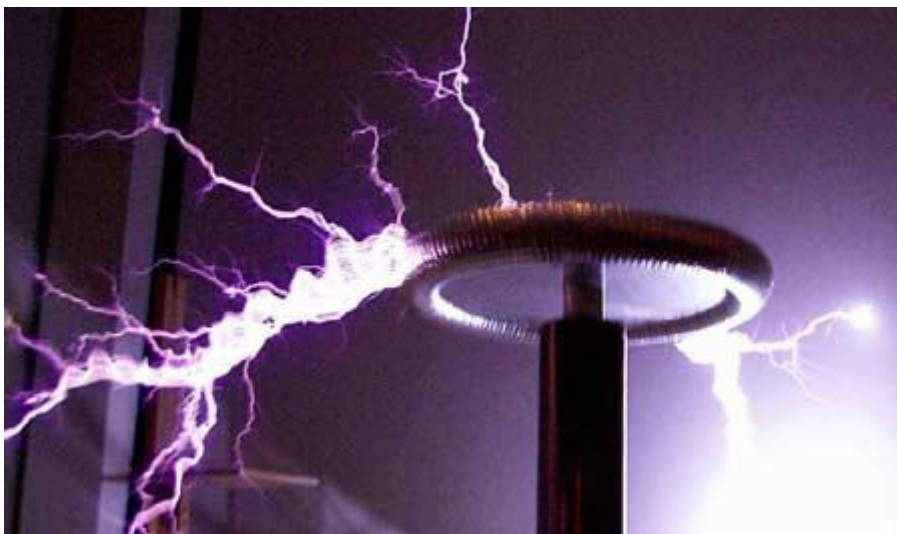
Slika 2.8. Fotografija udara munja – laboratorijski generirano pražnjenje [5].
