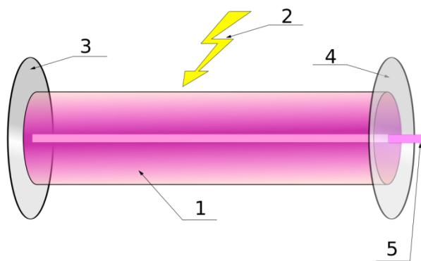
**Sl. 2.5.** Dijelovi lasera: 1)laserski medij, 2)energija za pobuđivanje medija, 3)potpuno reflektirajuće zrcalo 4)dijelom reflektirajuće zrcale 5)laserska zraka [14]
