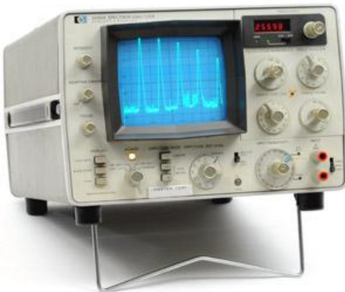
Slika 10. Analogni analizator spektra s katodnom cijevi [1]
