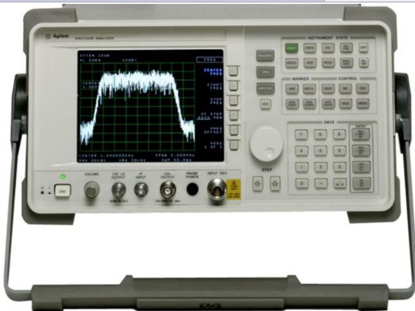
Slika 13. Prikaz spektralnog analizatora Agilent8564EC frekvencijskog opsega 9kHz do 40 GHz.
