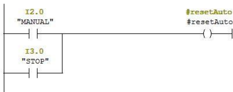
Slika 4.19. Prikaz direktne upotrebe ulaznog signala.
