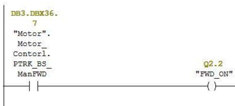
Slika 4.21. Mapiranje izlaznih digitalnih signala.
