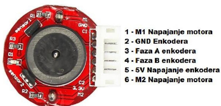
Slika 4.6. Prikaz ožičavanja motora i enkodera. [5]
