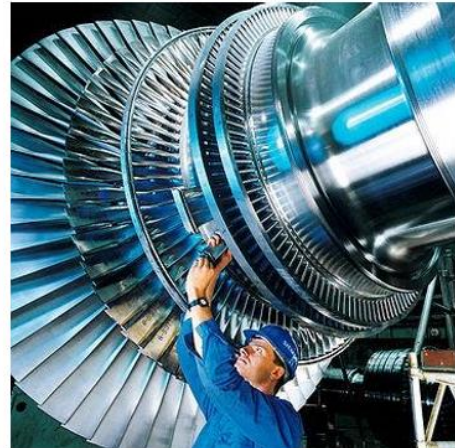
Rotor reakcijske parne turbine
