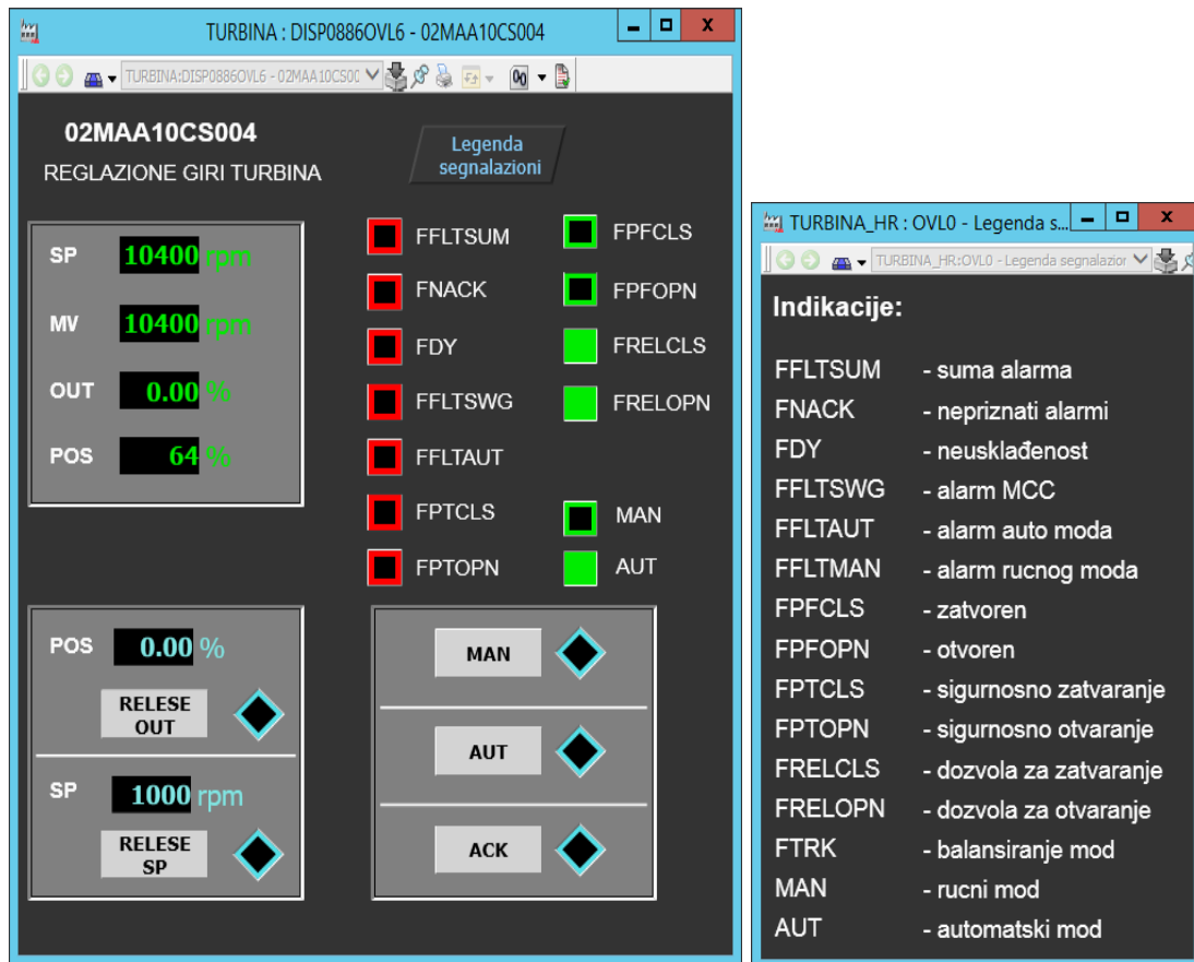
Slika 7.3 Sučelje regulatora brzine AG18
