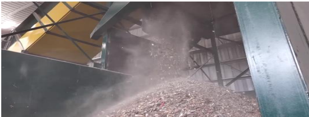
Sl. 4.2.2. Usitnjena keramika spremna za ponovnu proizvodnju
