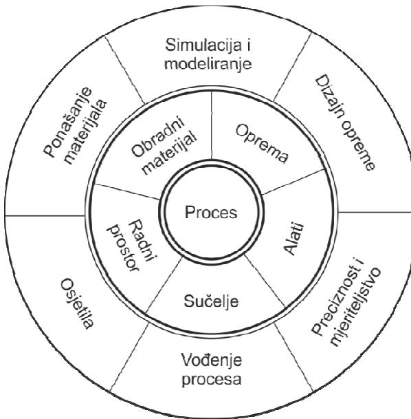
**Slika 3.7.** Komponente jediničnog procesa i potporni postupci [100], [97]
