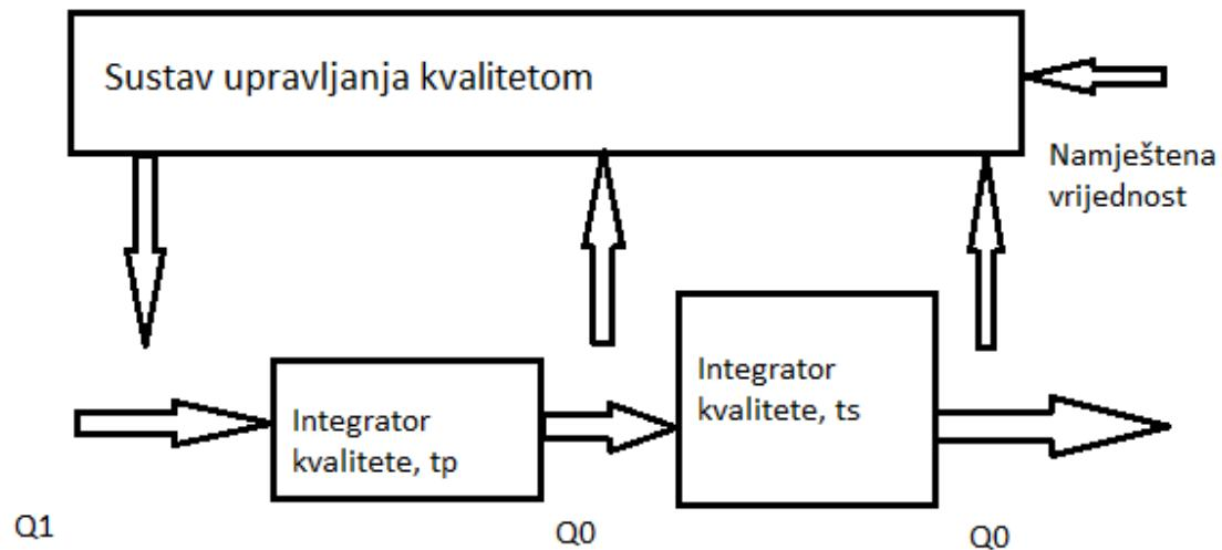
Slika 6.3. Dvostupnjevi postupak u sustavu kontrole kvalitete proizvoda
