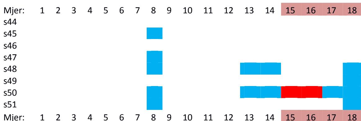
**Slika 5.7.** Impaktogram za signale dvokanalne peći pri radu s pločicama iz preše broj 10 - prvih 18 smjena u 8. mjesecu 2009 godine: bijela polja su različiti kodni znakovi prema znaku QC signala, a plava i crvena za iste kodne znakove mjernih signala i signala QC. Crvena polja označavaju gotovo identične iznose teselacijskih entropija temperturnih i QC signala
