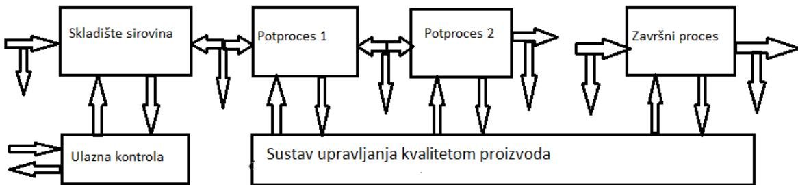
**Slika 6.1.** Shema sveobuhvatne kontrole kvalitete u proizvodnom procesu. Mjerni signali kvalitete i izvršni/kontrolni signali procesa naznačeni su strelicama od/i prema pojedinim procesnim dijelovima
