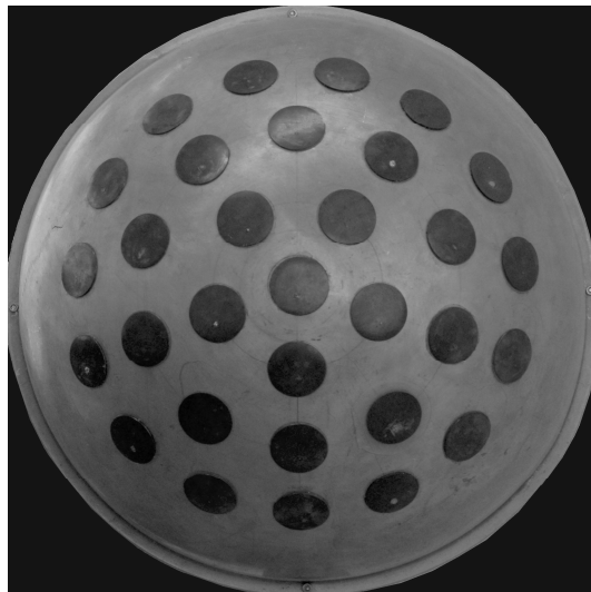
Slika 8.10. Sferni eksperimentalni model kojeg predstavljaju 31 kružna mikrotrakaste antena (radijus mikrotrakaste antene r_p=2,65 cm) na sferi radijusa r_s=30 cm raspoređenih u ikosaedarsku konfiguraciju [59].
