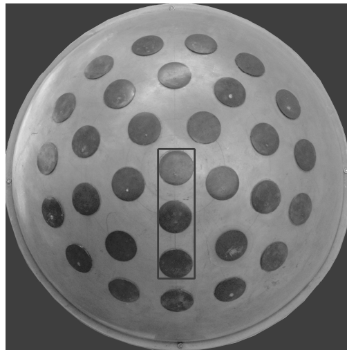
Slika 8.13. Drugi eksperimentalni podniz tri mikrotrakaste antene ( \alpha_6=0^0 , \beta_{61}=0^0 , \alpha_5=15^0 , \beta_{51}=0^0 , \alpha_4=30^0 , \beta_{41}=0^0 ) [59].
