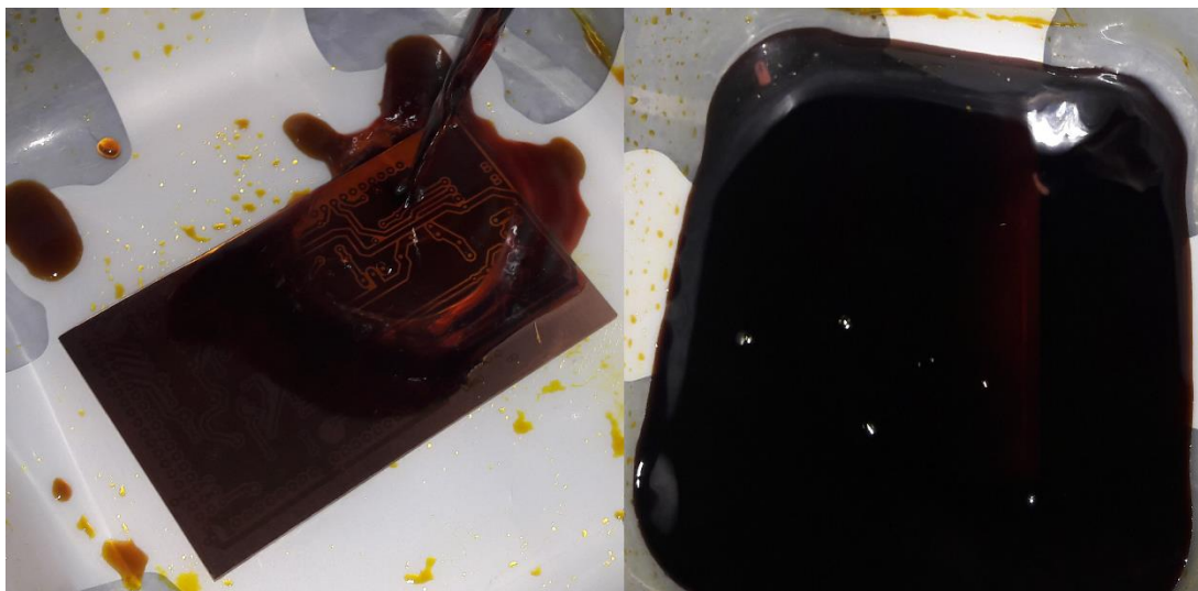
Sl. 3.23. Jetkanje tiskane pločice
