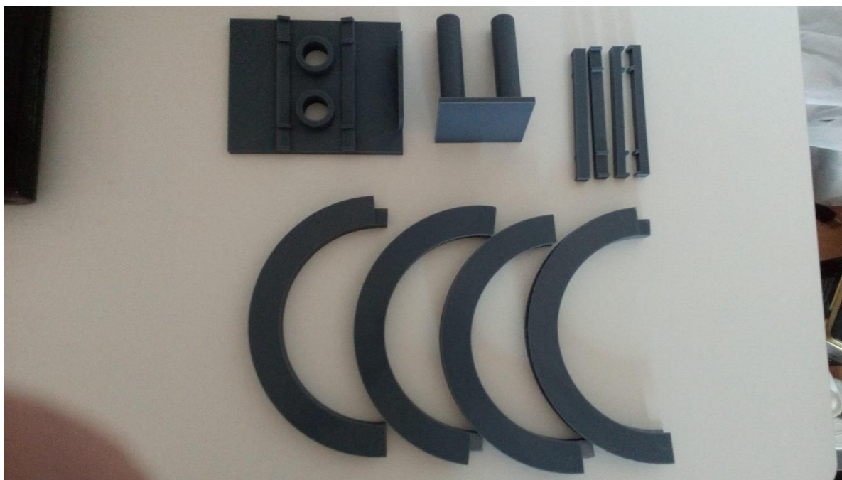
Slika 5.5. Isprintani i očišćeni dijelovi zavojnica
