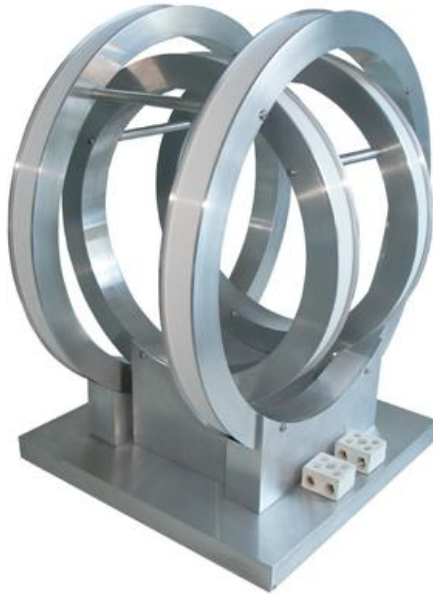
Slika 3.2. Helmholtzov sustav svitaka sa dva para svitaka [12]
