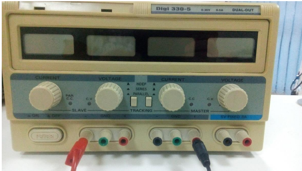
Slika 5.10. Istosmjerni izvor Digi 330-5
