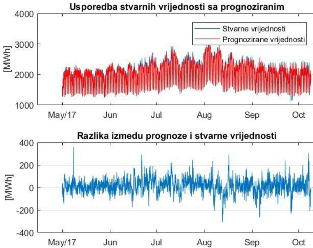
Slika 5.11. Usporedba stvarnog opterećenja sa prognoziranim
