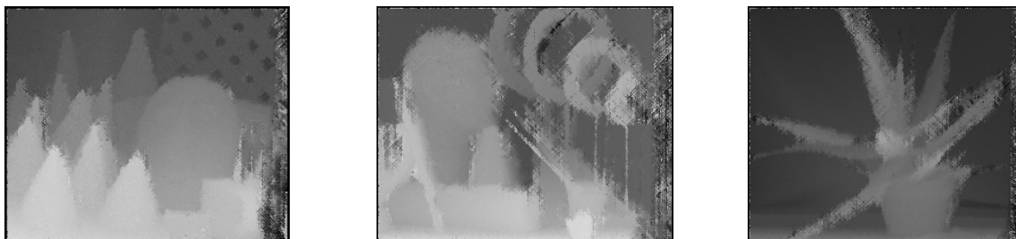
Slika 5.3. Primjeri slike dispariteta dobivenih SGM-Census metodom
