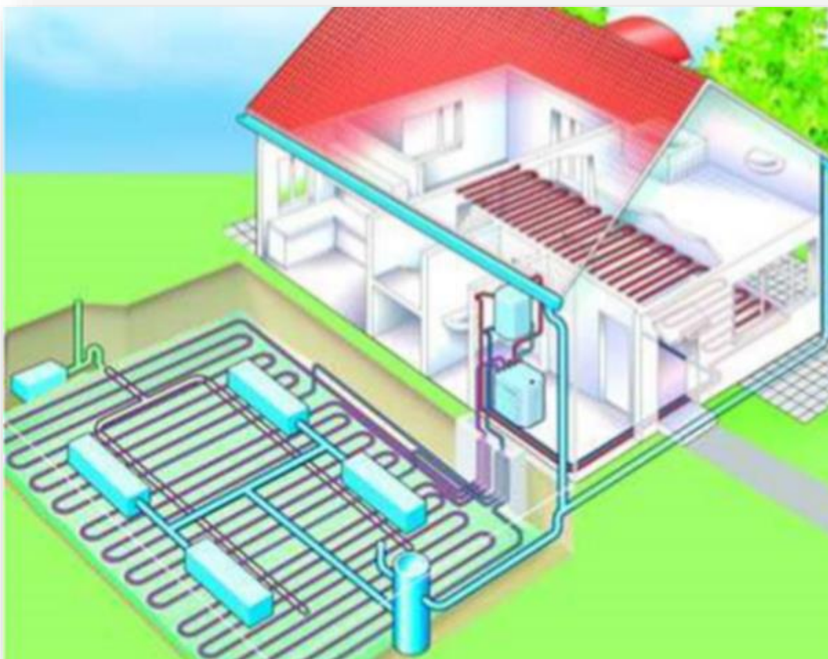
Slika 2.5 Dizalica topline spojena na sustav podnog grijanja, [3, 4].
