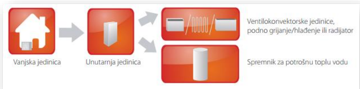
Slika 2.6 Shema rada dizalice topline zrak-voda, [2].
