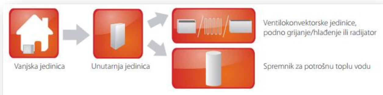
Slika 2.6 Shema rada dizalice topline zrak-voda, [2].
