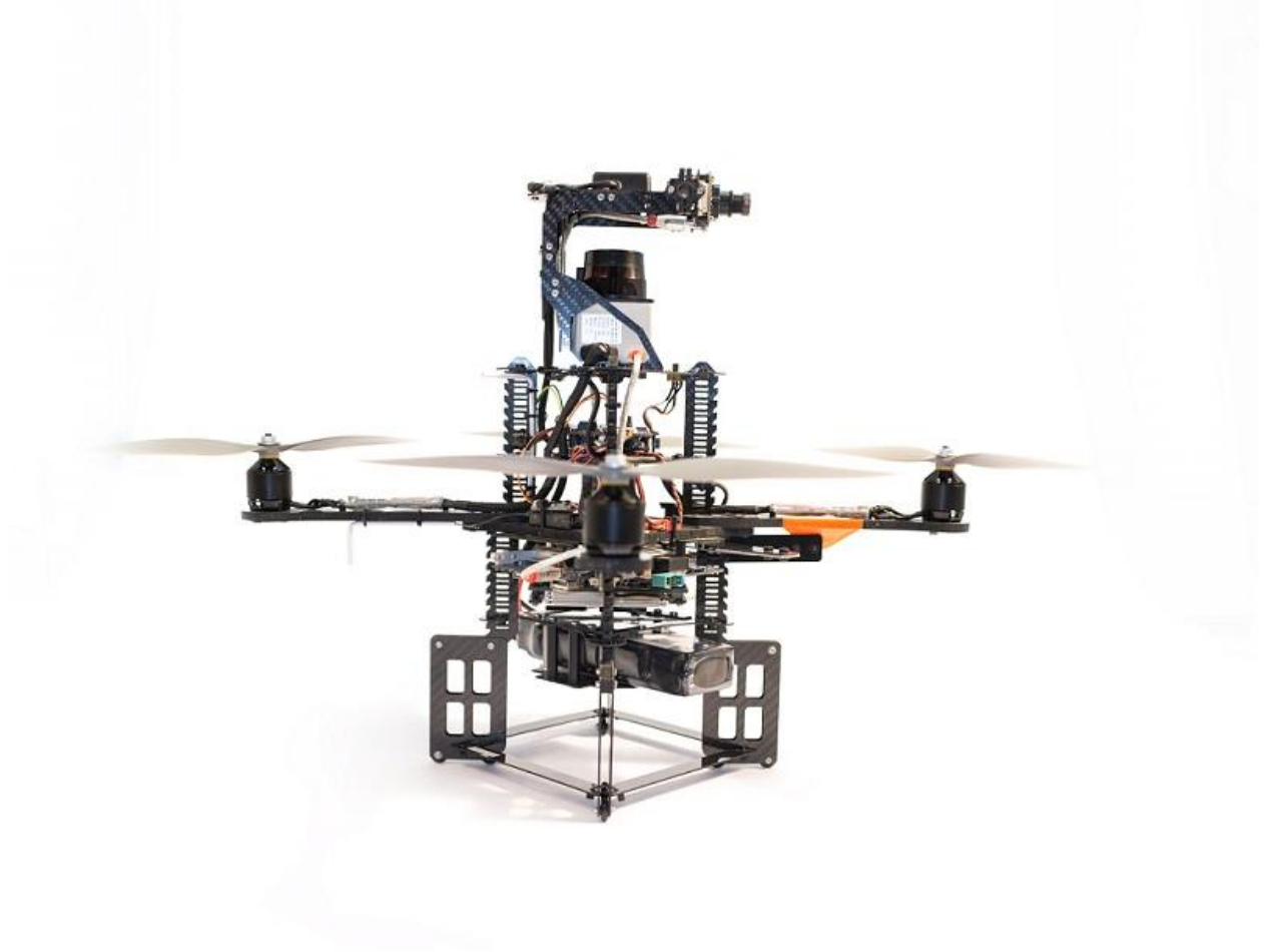
Slika 6.1 AscTec™ Pelican UAV mjerna platforma [22].
