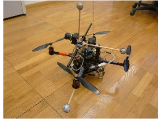
Slika 6.6 AscTec™ Pelican s tri reflektirajuće točke [25].
