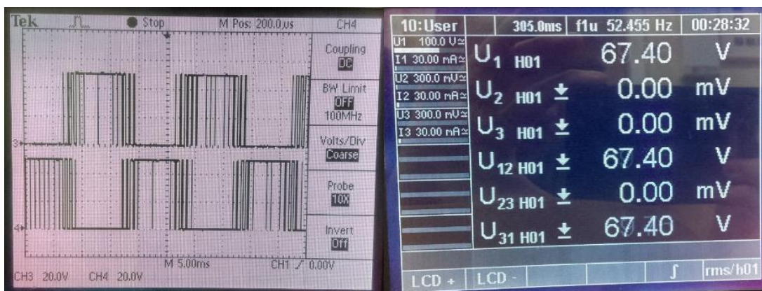
Slika 5.7. – a) vođenje para MOSFET-a, b) Napon osnovnog harmonika (50 Hz)
