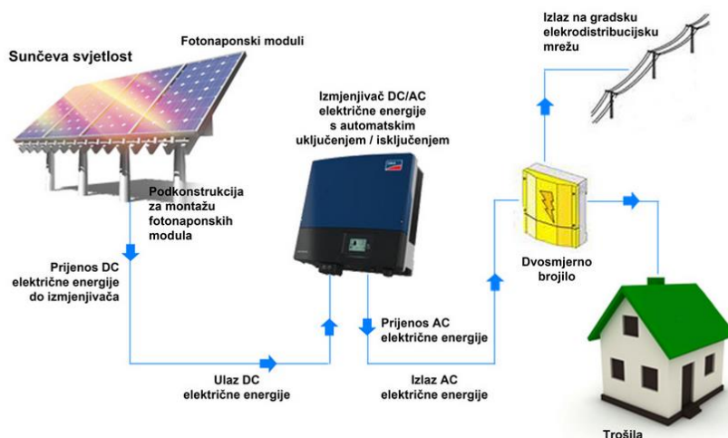
Slika 4.2. Mrežni fotonaponski sustav [17]
