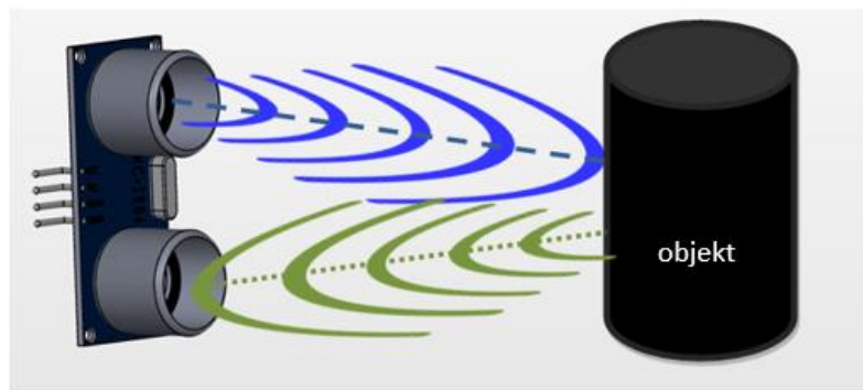
Slika 2.7. Rad ultrazvučnog senzora HC-SR04 [11]
