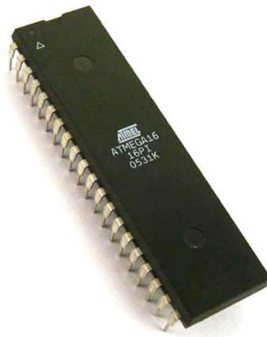
Slika 2.10. Izgled Atmega16 mikroupravljača [17]
