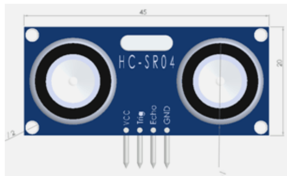
Slika 2.9. Izgled senzora HC-SR04 [11]
