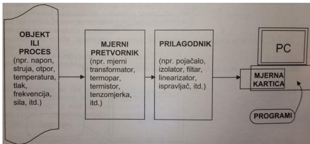
Sl. 2.16: Blok dijagram automatiziranog mjernog sustava.[1]
