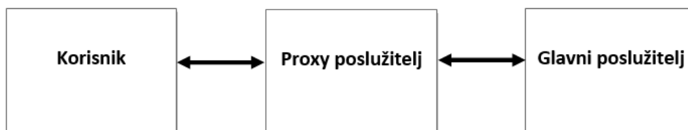
Sl. 3.4. Struktura klijent-poslužitelj s proxy poslužiteljem
