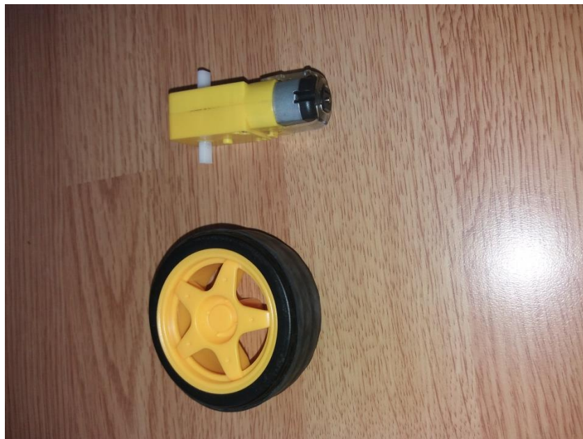
Sl. 3.5. 3-6V DC motor s prijenosom i kotačima
