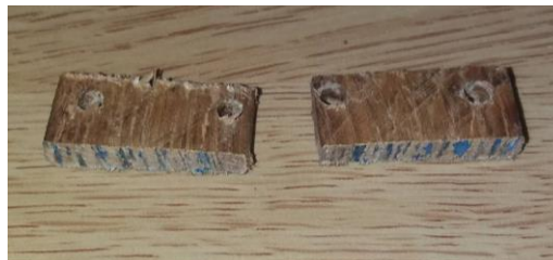
Sl. 3.7. Lamelice koje se postavljaju s unutarnje strane kutije
