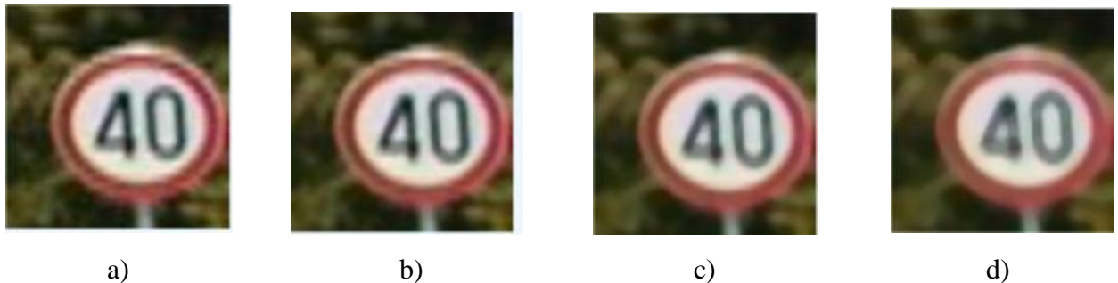
Slika 3.3. Usporedba različitih veličina prozora za primjenu medijan filtera (veličina svih slika 100x100 piksela): veličina prozora vrijednosti 3 (b), veličina prozora vrijednosti 5 (c), veličina prozora vrijednosti 7 (d) u odnosu na originalnu sliku (a)
