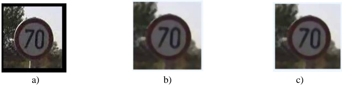
Slika 3.5. Usporedba djelovanja medijan filtra (veličina prozora medijan filtra iznosa 5) na originalnu sliku (a) različitim pozivom metoda: SmoothMedian funkcija (b) i MedianBlur funkcija (c)
