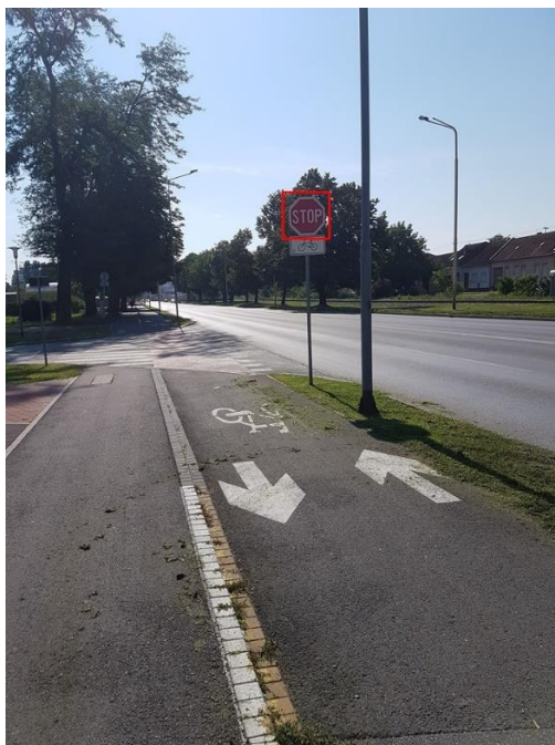
Sl. 4.6. Primjer točne pozitivne detekcije detektora prometnog znaka obveznog zaustavljanja
