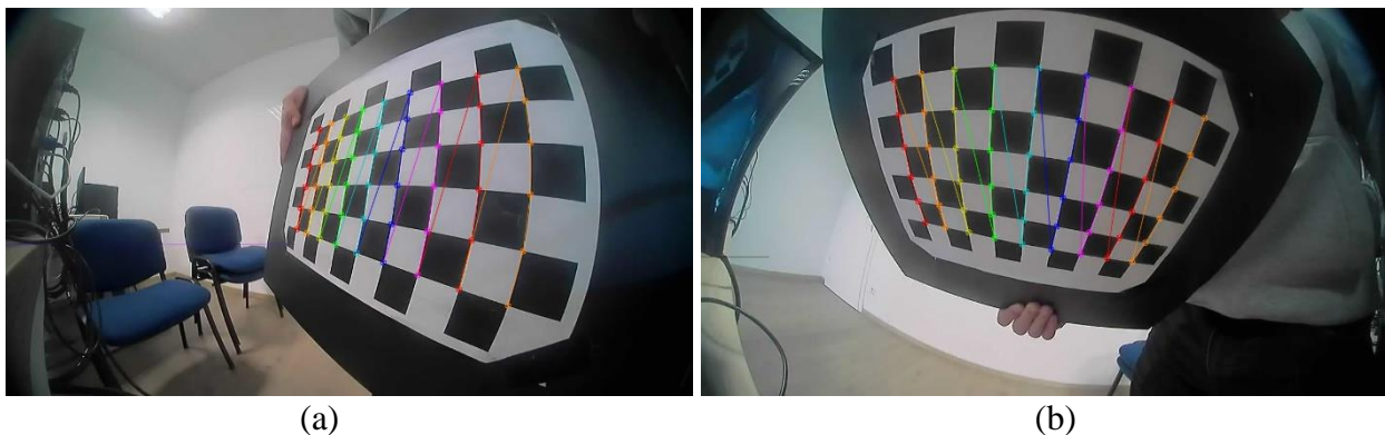
SI.3.4. Naznačene spojne točke na kalibracijskim slikama prilikom kalibracije kamere (a) kalibracijska slika 1, (b) kalibracijska slika 2
