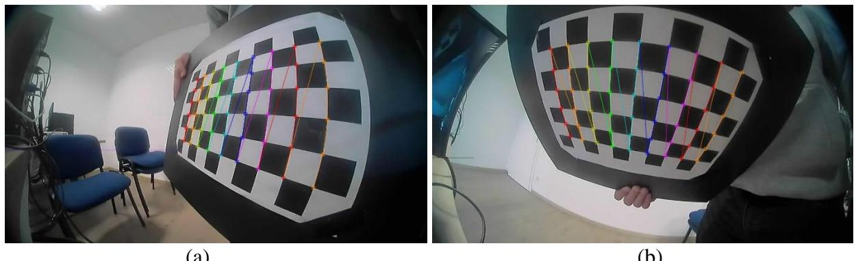
**Sl.3.4.** Naznačene spojne točke na kalibracijskim slikama prilikom kalibracije kamere (a) kalibracijska slika 1, (b) kalibracijska slika 2
