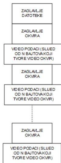
Sl. 3.3 Struktura datoteke koja sadrži video podatke i koja se šalje s PC-a na AMV Grabber uređaj
