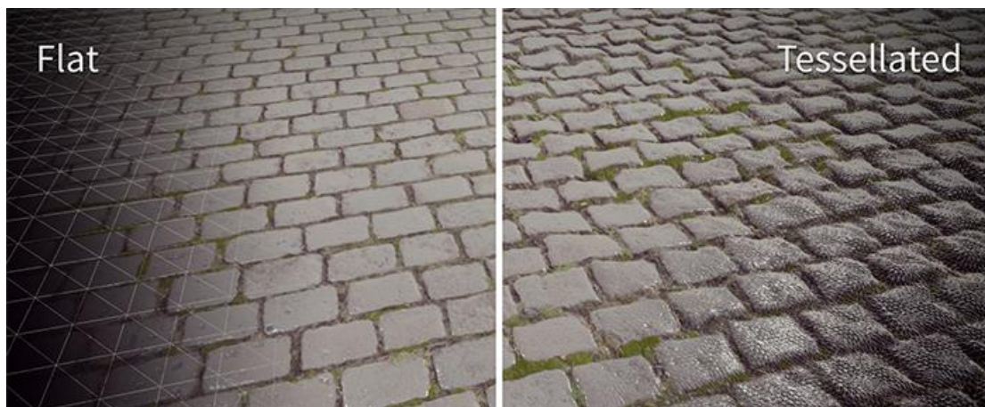
Sl. 2.7. Prikaz teselacijskog shadera na primjeru kaldrme.
