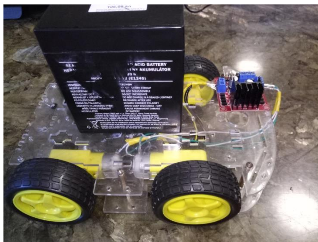
Slika 3.12. Platforma nakon dodanog napajanja
