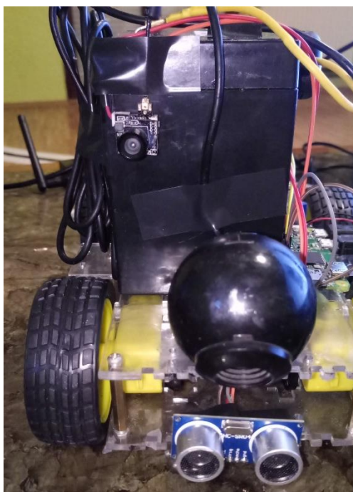
Slika 3.15. Platforma nakon dodane mini FPV kamere
