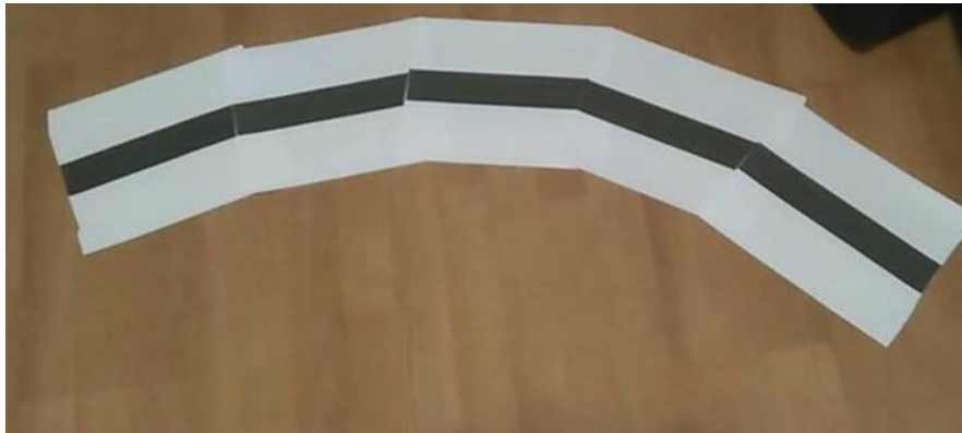
Slika 3.27. Line tracking staza
