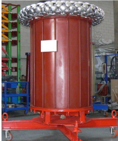
Sl.5.1.4. Ispitni transformator tipa cilindar
