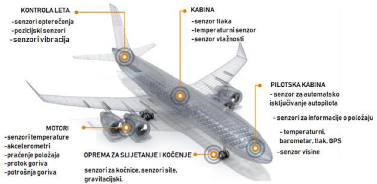
Slika 5.6. Smart senzori u avionu. [13]
