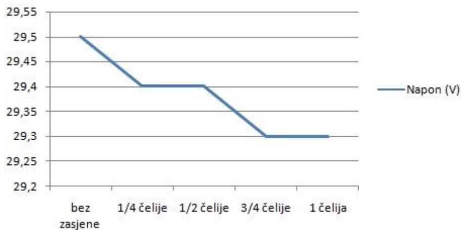
**Slika 4.26.** Promjena napona s obzirom na zasjenjenje četvrtina fotonaponske čelije.
