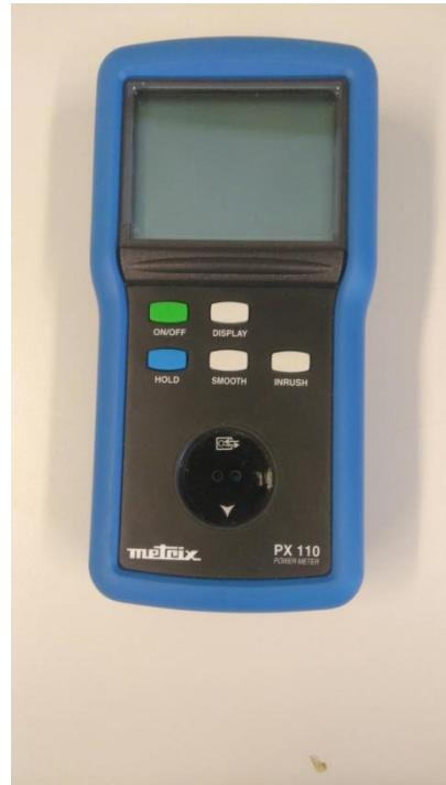
**Slika 4.5.** Mjerni uređaj Metrix PX-110 Powermeter
