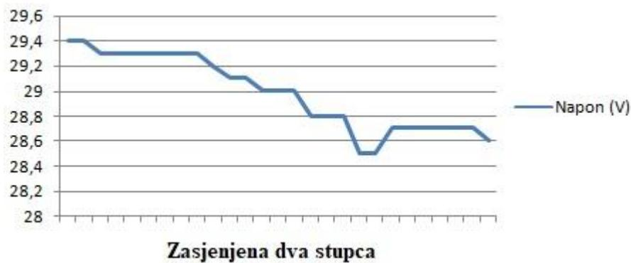
**Slika 4.27.** Promjena napona pri zasjeni dva stupca fotonaposkog modula.
