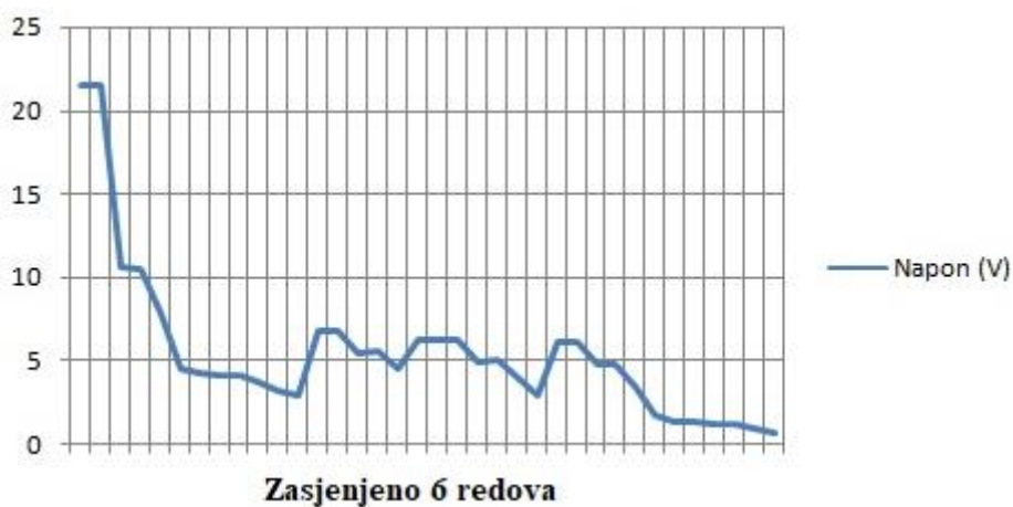
Slika 4.16. Promjena napona pri zasjeni 6 redova modula
