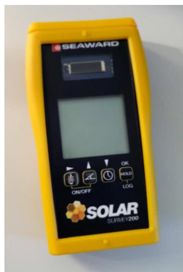
Slika 4.7. Mjerni uređaj Seaward SOLAR Survey200
