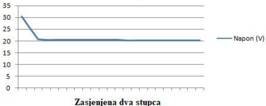
Slika 4.19. promjena napona pri zasjeni dva stupca fotonaposkog modula.
