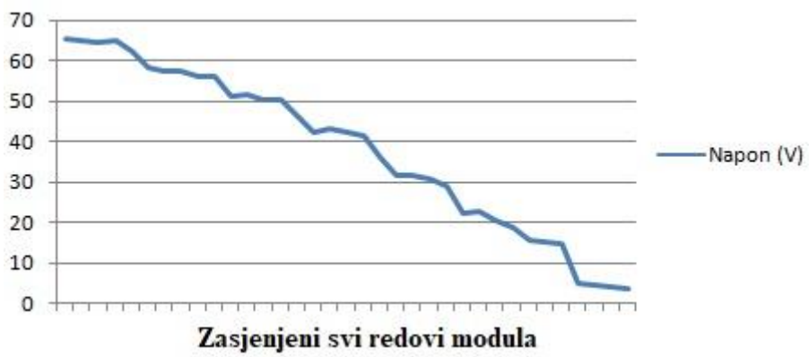
Slika 4.51. Zasjenjeni svi redovi modula
