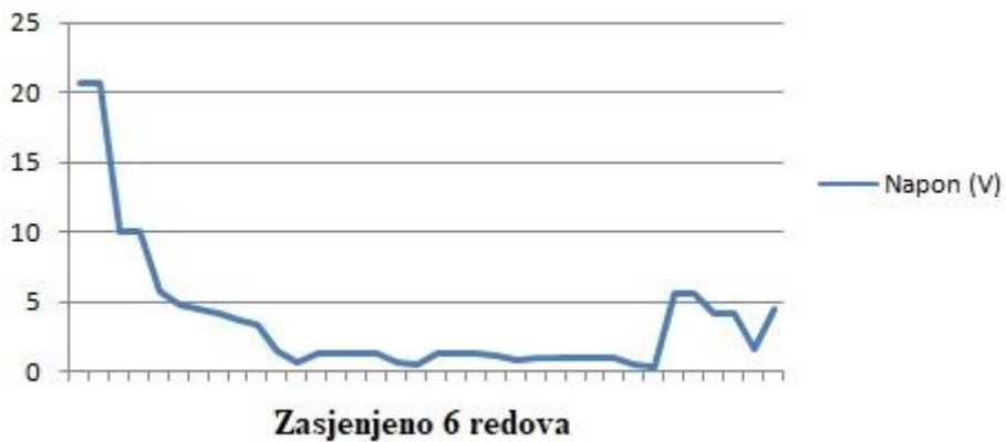
Slika 4.24. Promjena napona pri zasjeni 6 redova modula
