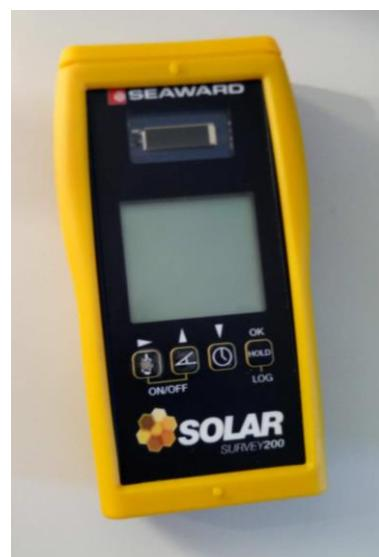
**Slika 4.7.** Mjerni uređaj Seaward SOLAR Survey200
