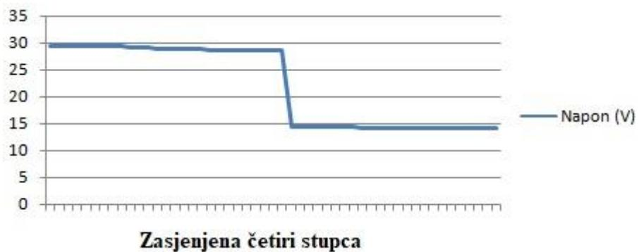
**Slika 4.28.** Promjena napona pri zasjeni četiri stupca fotonaposkog modula.
