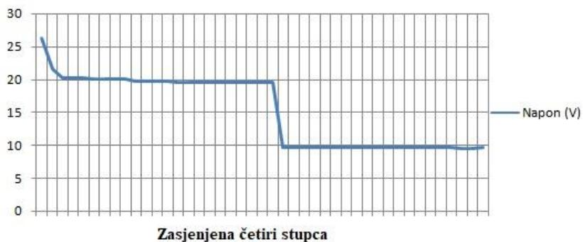
**Slika 4.12.** Promjena napona pri zasjeni četiri stupca fotonaponskog modula.
