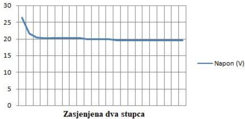
**Slika 4.11.** Promjena napona pri zasjenjeni dva stupca fotonaposkog modula.
