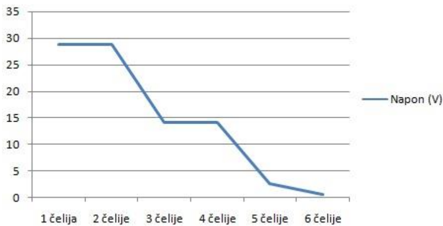
Slika 4.30. Promjena napona pri zasjeni 6 ćelija u prvom redu fotonaponskog modula.
