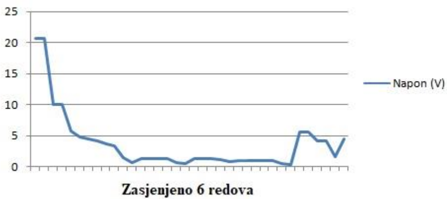
Slika 4.24. Promjena napona pri zasjeni 6 redova modula
