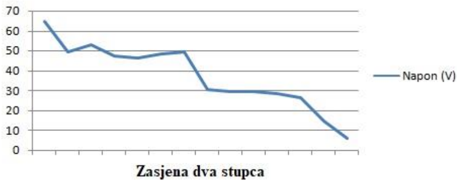
Slika 4.45. Zasjenjena dva stupca modula
