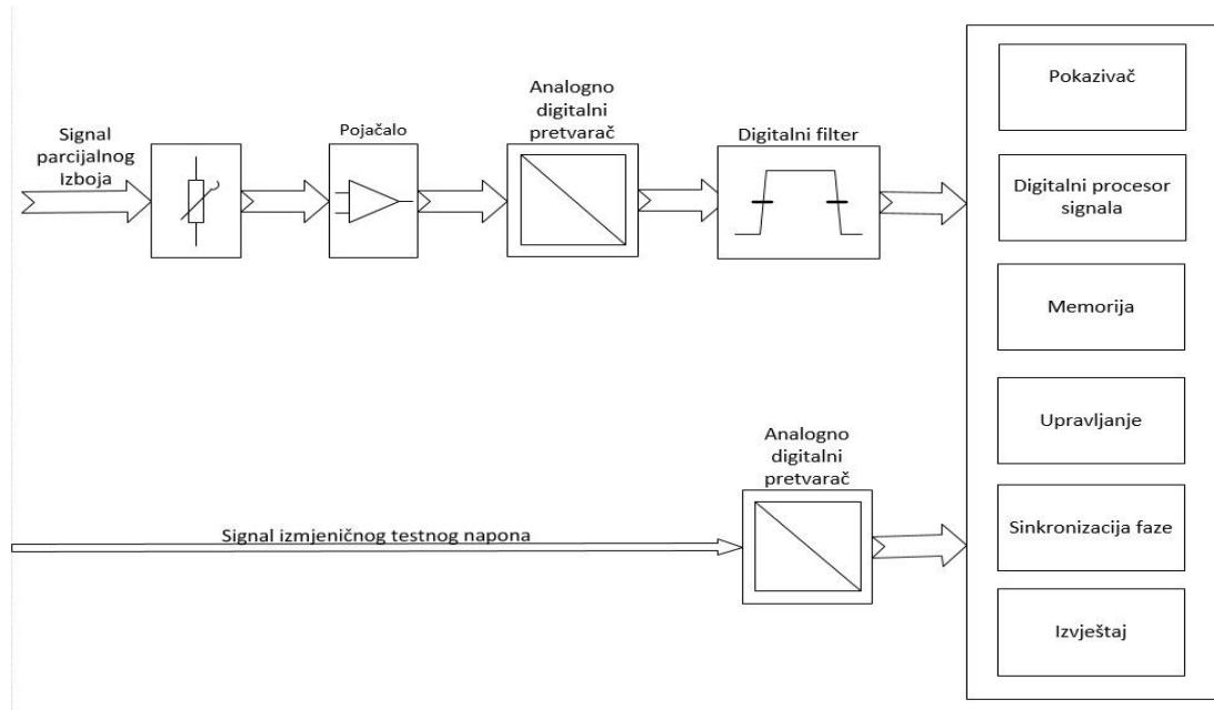
**Slika 5.3.** Blok dijagram direktne pretvorbe pojačanog signala kod digitalnih uređaja
