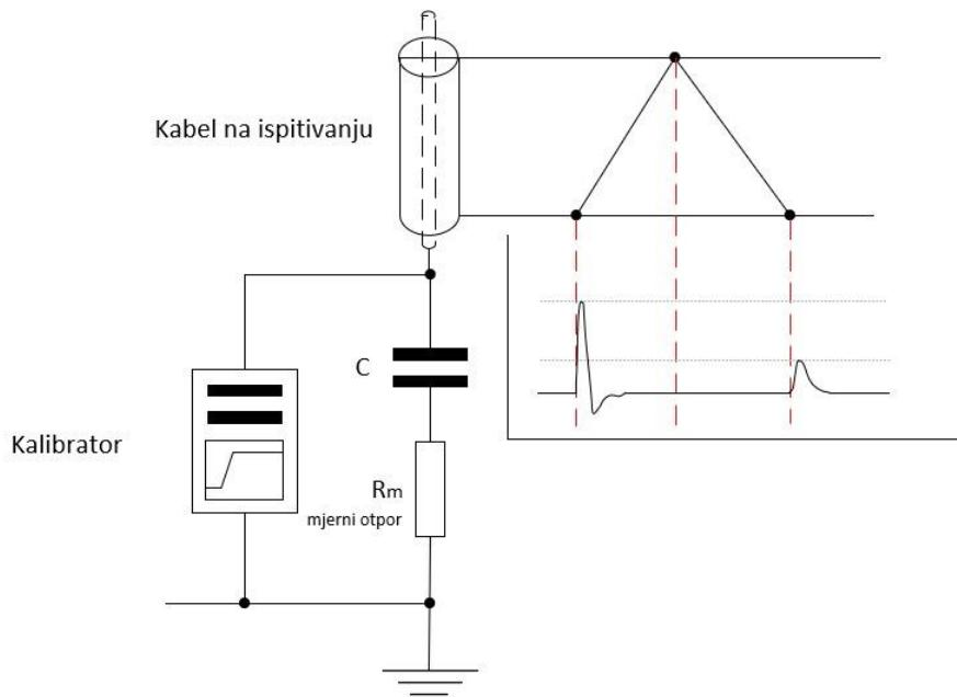
**Slika 6.1.** Princip lokalizacije parcijalnih izboja u električnim kabelima
