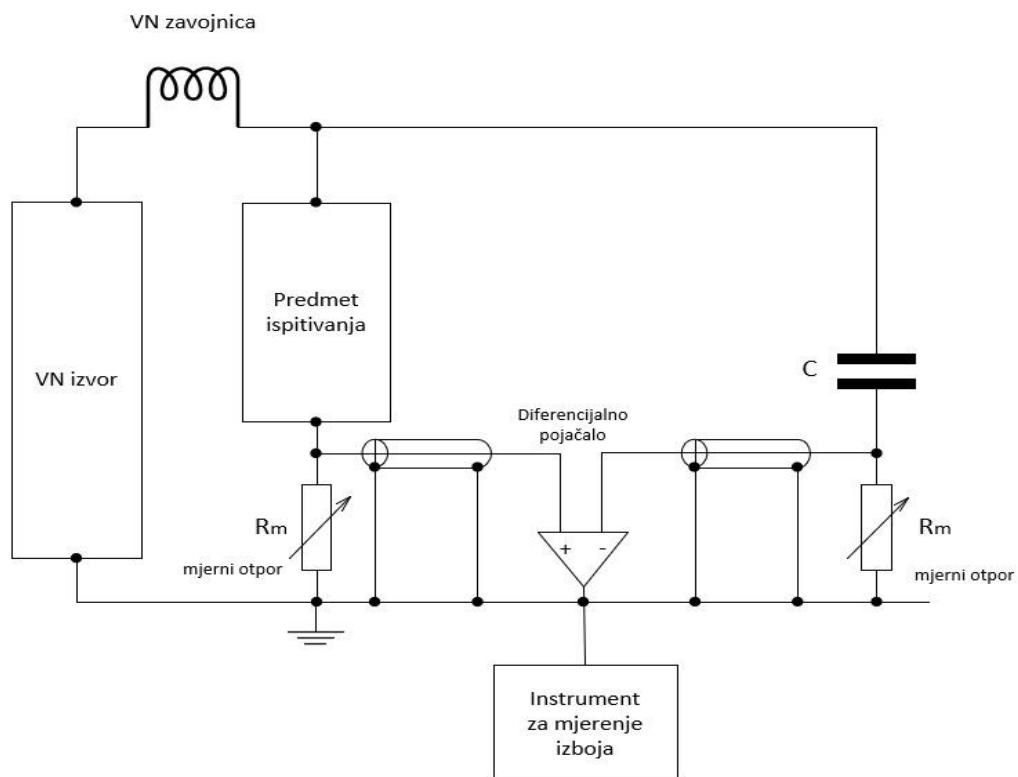
**Slika 5.1.** Osnovni spoj za mjerjenje parcijalnih izboja po standardu IEC 60270:2000
