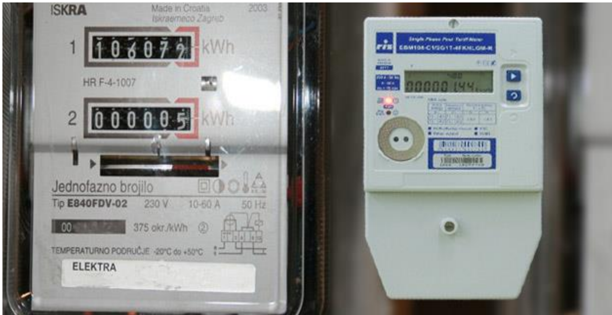
Slika 3.5. Prikaz elektromehaničkog i pametnog brojila [12]
