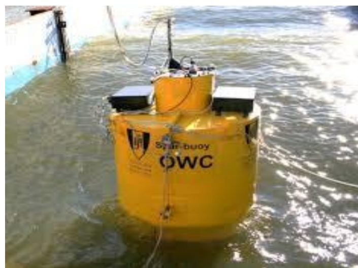
Sl. 3.15. Model Spar Bouy-a u omjeru 1:10
