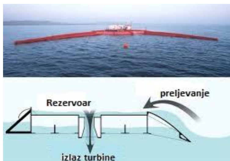
Sl. 3.33. Prototip Wave Dragon uređaja postavljenog u Danskoj 2003. godine
