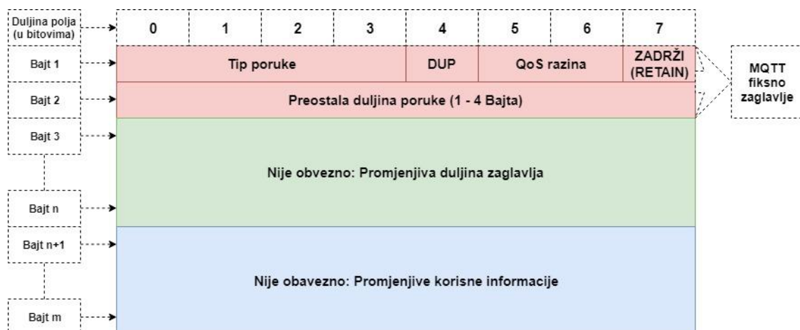
Sl. 2.13. Opći oblik MQTT paketa [12].
