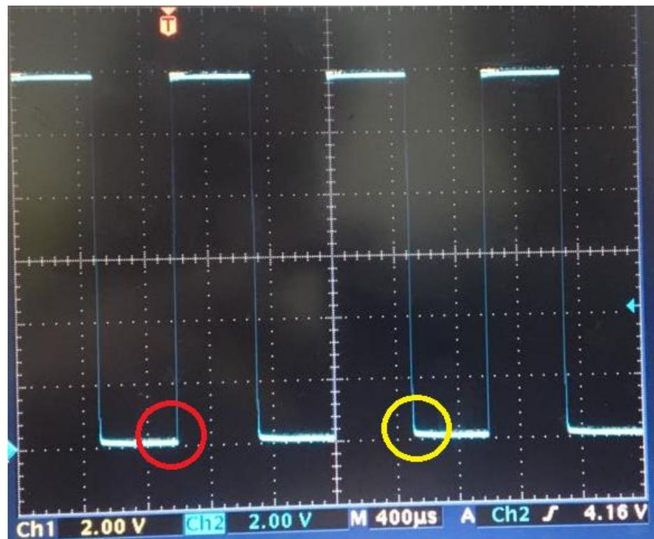
Slika 5.4 Upravljački signali MOSFET-a Q1 i Q2.
