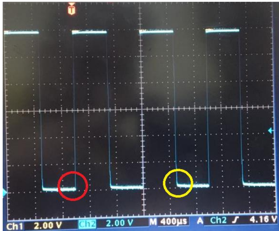
Slika 5.4 Upravljački signali MOSFET-a Q1 i Q2.
