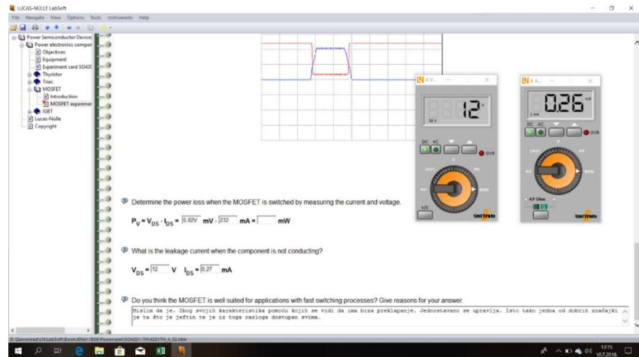
Slika 3.7 Mjerenje struje propuštanja pomoću LabSofta.
