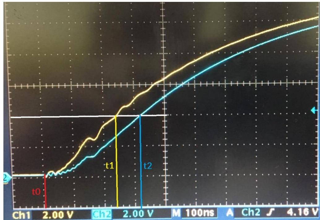
Slika 5.7 Upravljački signali pri dodanom otporu od  $30 \Omega$ .
