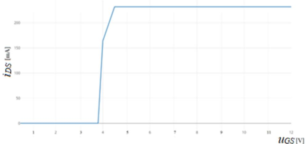
Slika 3.5 Ovisnost izlazne struje o upravljačkom naponu MOSFET-a.
