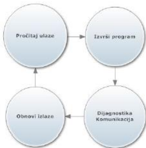
Slika 3.1. Princip rada PLC-a
