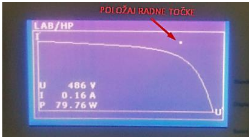
Slika 3.7. Položaj radne točke izvan karakteristike[3]
