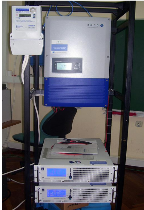
Slika 2.1. Emulator fotonaponskog sustava
