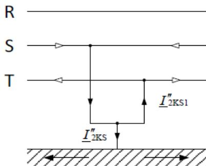
Slika 4.10. Shematski prikaz dvofaznog kratkog spoja sa zemljom
