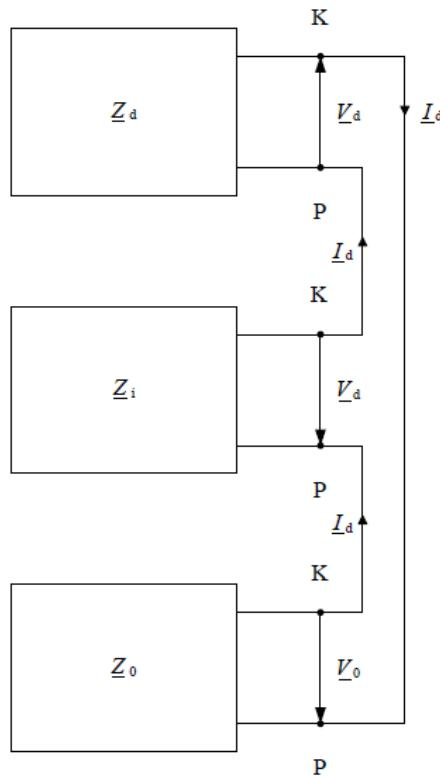
Slika 4.6. Jednofazni kratki spoj - mjerodavne komponente
