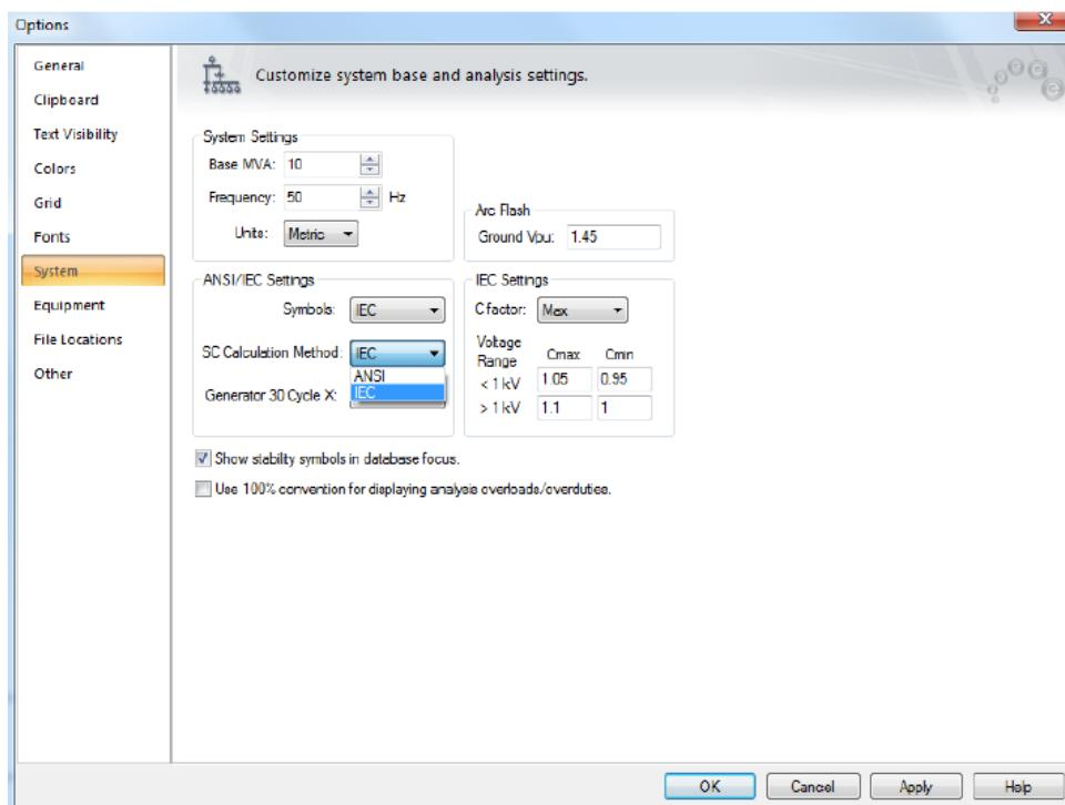
Slika 4.12. postavke za IEC metodu proračuna kratkog spoja
