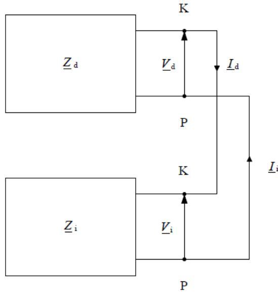
Slika 4.9. Dvofazni kratki spoj - mjerodavne komponente
