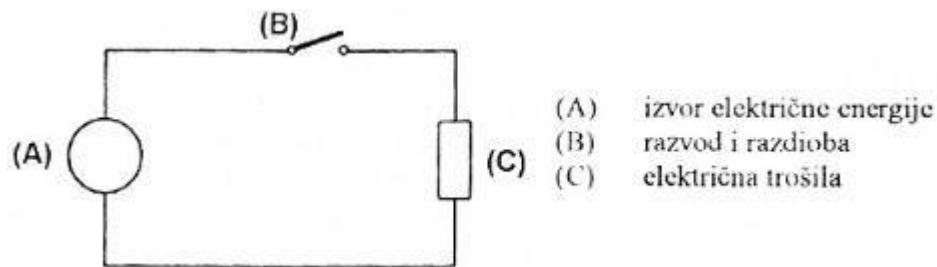
Slika 2.1. Pojednostavljena shema brodskog električnog strujnog kruga
