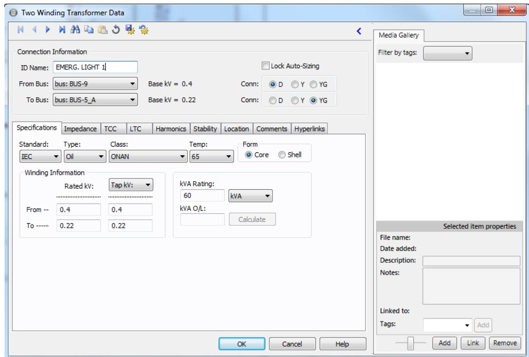
Slika 4.8. Podešavanje parametara transformatora (EMERG.LIGHT 1 i EMERG.LIGHT 2)
