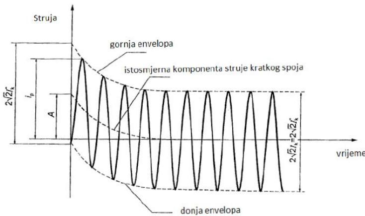
Slika 4.14. Struja kratkog spoja za slučaj kratkog spoja daleko od generatora (konstantna izmjenična komponenta)
