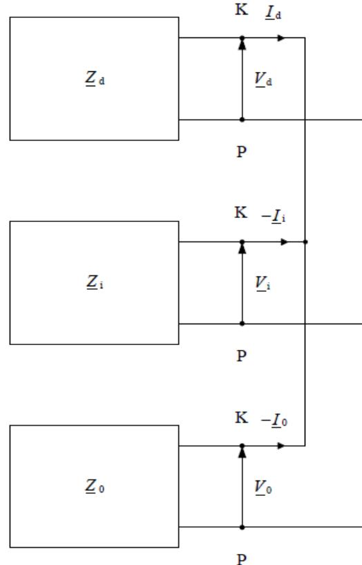
Slika 4.12. Dvofazni kratki spoji sa zemljom – mjerodavne komponente
