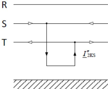
Slika 4.7. Shematski prikaz dvofaznog kratkog spoja
