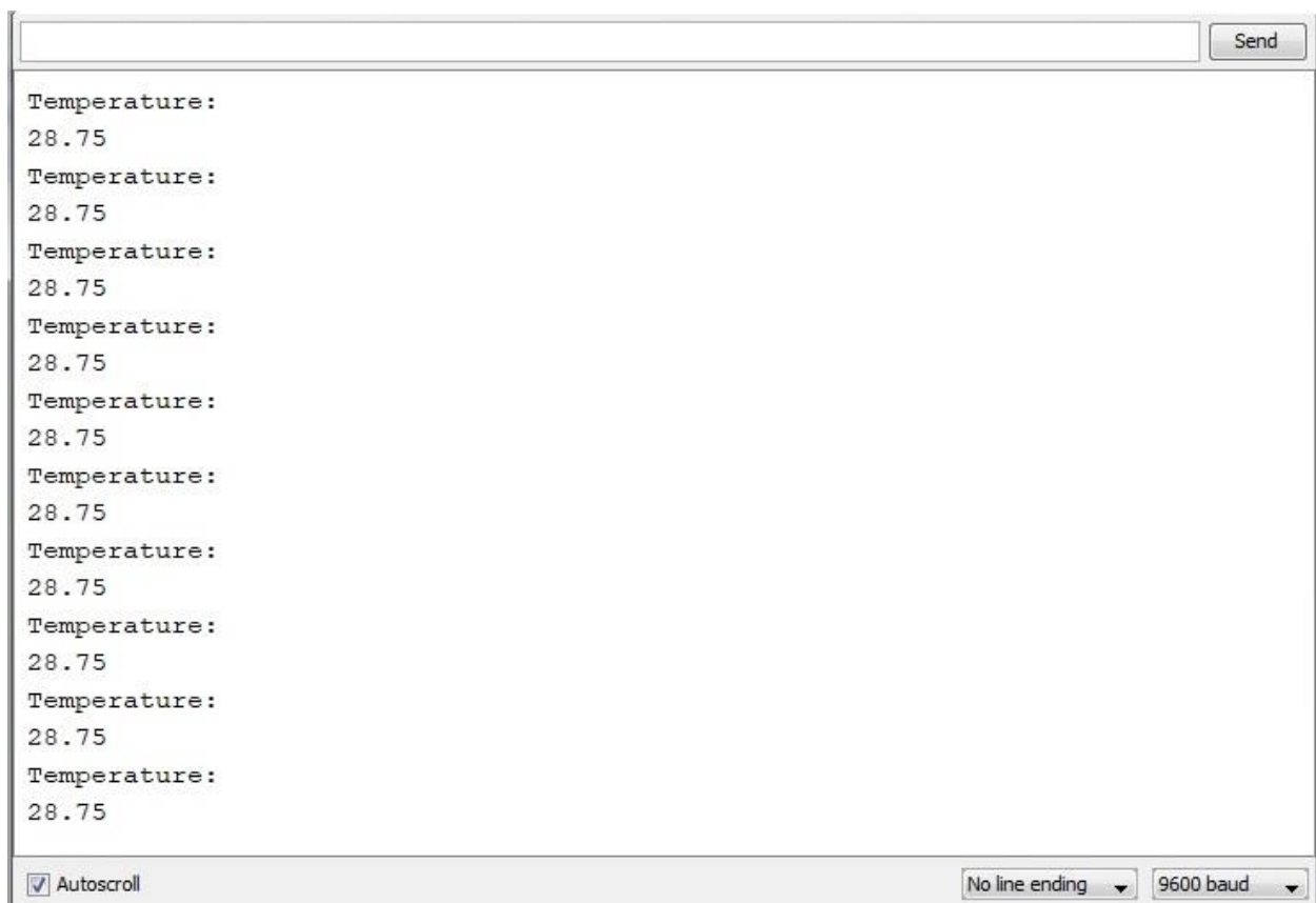
Slika 5.2. Serijski monitor s rezultatima koda.
