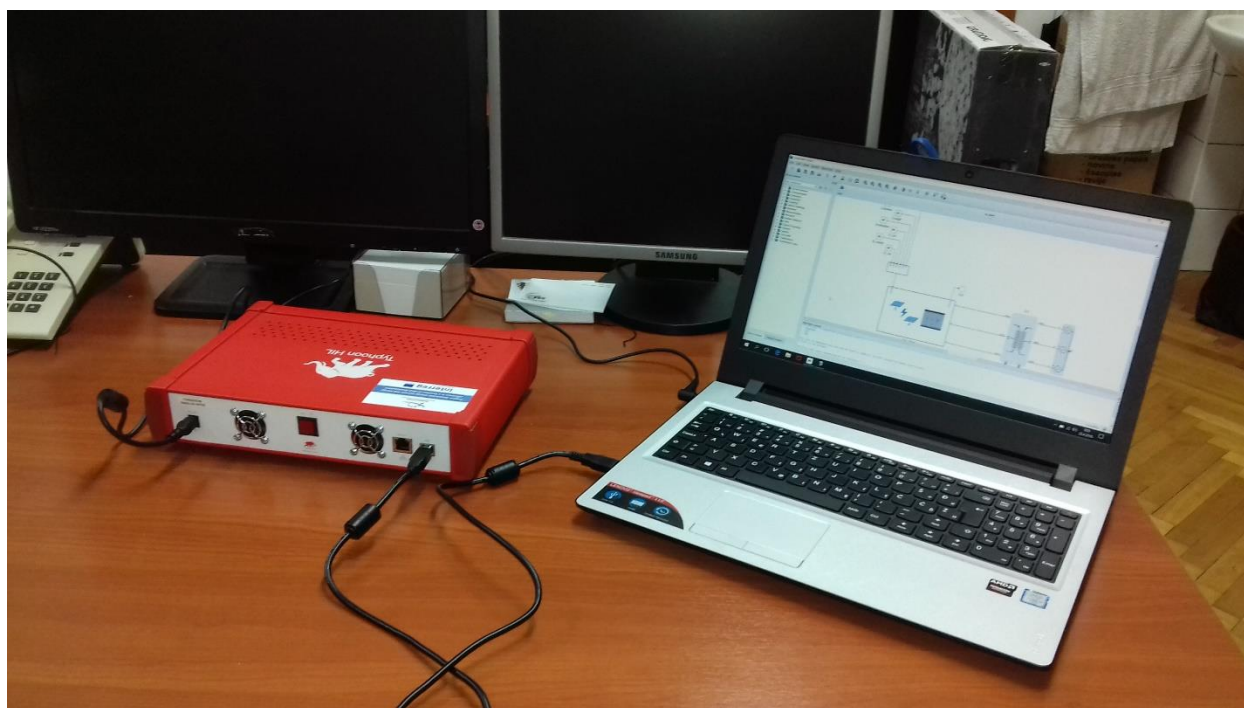
Sl. 4.1. Provođenje simulacije pomoću Typhoon HIL software-a i hardware-a
