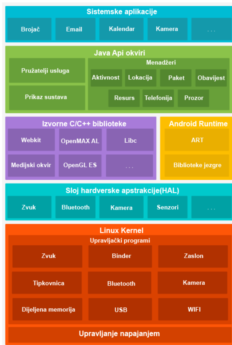
Slika 1.2. Android arhitektura (izvor: https://developer.android.com/guide/platform .)
