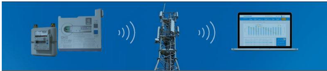
Sl. 4.2. Prikaz daljinsko očitavanja prirodnog plina
