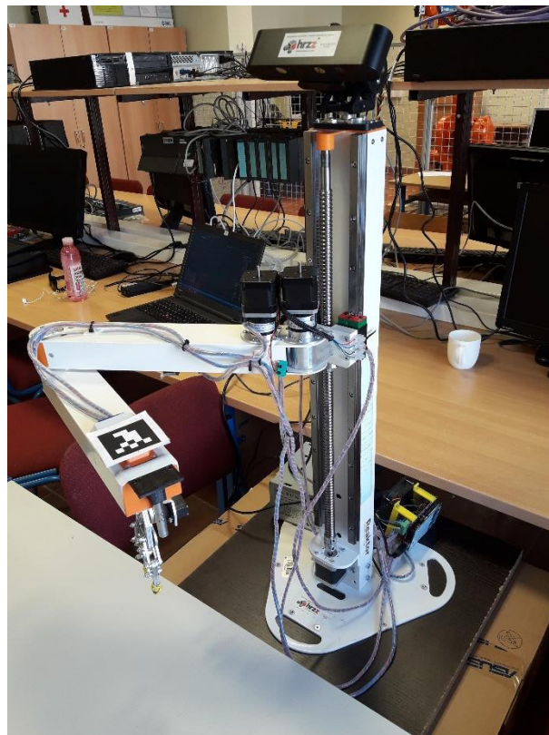
Slika 4.1. Robotski manipulator u SCARA konfiguraciji
