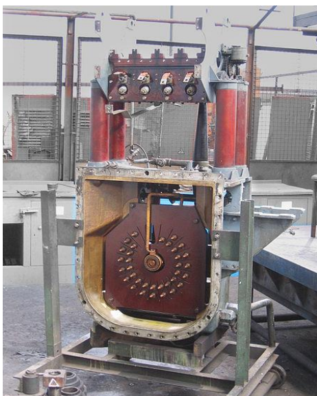
Slika 4.63. Regulacijska preklopka unutar transformatora [22]
