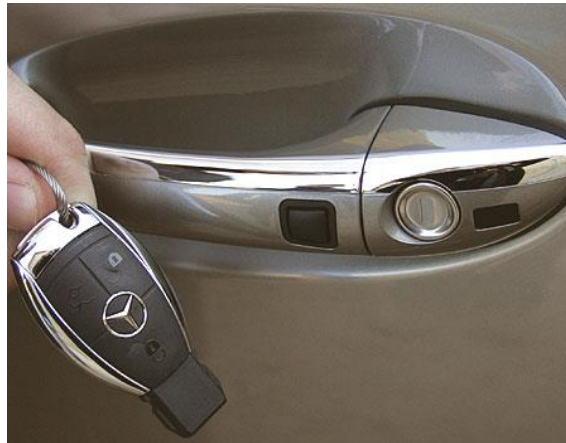
Sl. 2.4. „KeylessGo System“ proizvođača Mercedes-Benz.
