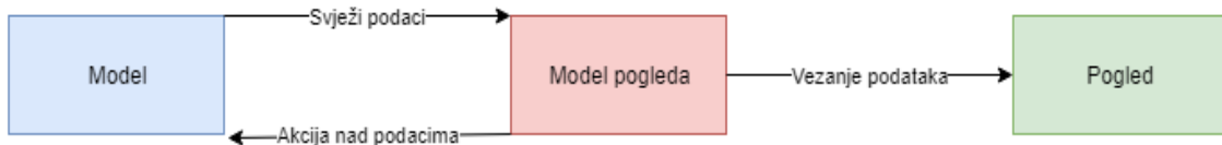
Slika: 2.3 MVVM struktura i tok podataka
